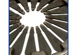
Levier d'embrayage ou bouts de doigts du diaphragme pliés
