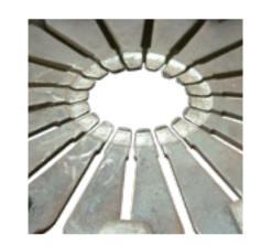
Usure prématurée du bout des doigts du diaphragme du plateau
