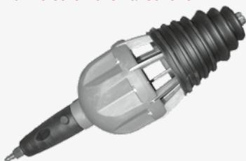
Die universellen Achsmanschetten lassen sich sowohl getriebeseitig, als auch radseitig montieren. Mit dem passendem Montagewerkzeug lassen sich die Manschetten auf bis zu 10 cm dehnen und ermöglichen einen einfachen und schnellen Einbau. Der Komplettausbau der Gelenkwelle/Antriebswelle ist somit nicht mehr notwendig!
